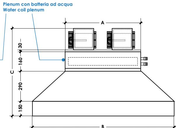
**BARRIERE CON BATTERIA AD ACQUA
