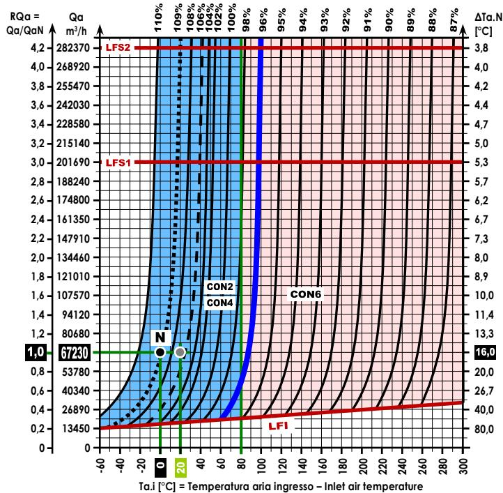
Alcuni Rendimenti  $\eta$  (=  $\eta$  totale @Hi) in vari Punti di progetto (funzionamento) GH-CON (Moduli a Condensazione con modulazione istantanea di fiamma già alla massima portata termica)
