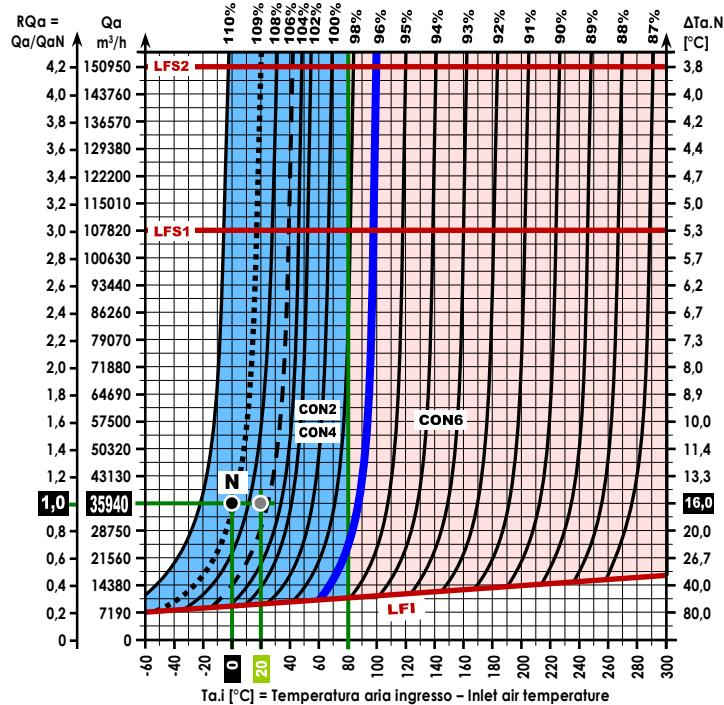
Alcuni Rendimenti  $\eta$  (=  $\eta$  totale @Hi) in vari Punti di progetto (funzionamento) GH-CON (Moduli a Condensazione con modulazione istantanea di fiamma già alla massima portata termica)
