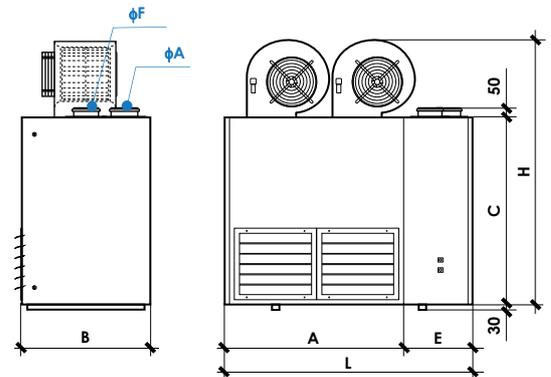
Versione adatta per installazione VERTICALE - Version suitable for VERTICAL installation
