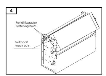
Batteria addizionale 1R\_Trasformazione unità da 2T a 4T\_Unità Orizzontale 1R Additional Coil\_ Unit transformation from 2T to 4T\_Horizontal Unit
