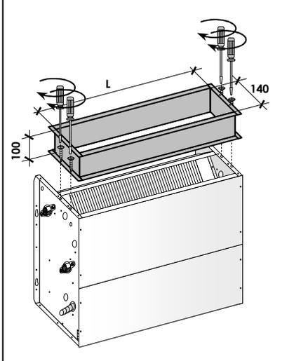
**Esempio 3 (Installazione su versione incasso verticale con mandata aria frontale) - Example 3 (Installation on vertical concealed version with front air supply)**
