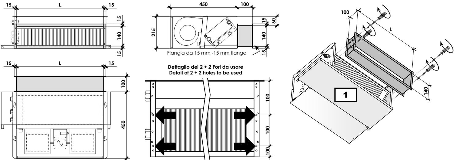
**Esempio 2 (Installazione su versione incasso verticale con mandata aria superiore) - Example 2 (Installation on vertical concealed version with top air supply)**
