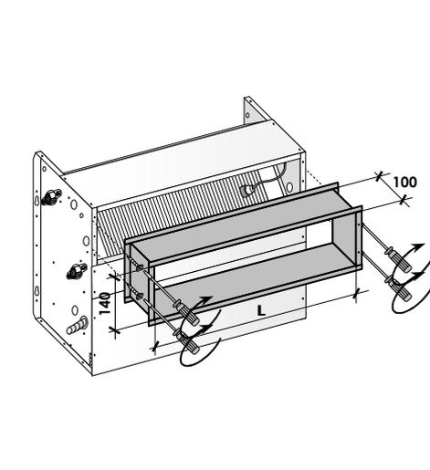
**Esempio 4 (Installazione su plenum a 90° di aspirazione aria e plenum a 90° di mandata aria (accessori) - Example 4 (Installation on air intake 90° plenum and air supply 90° plenum (accessories))**
