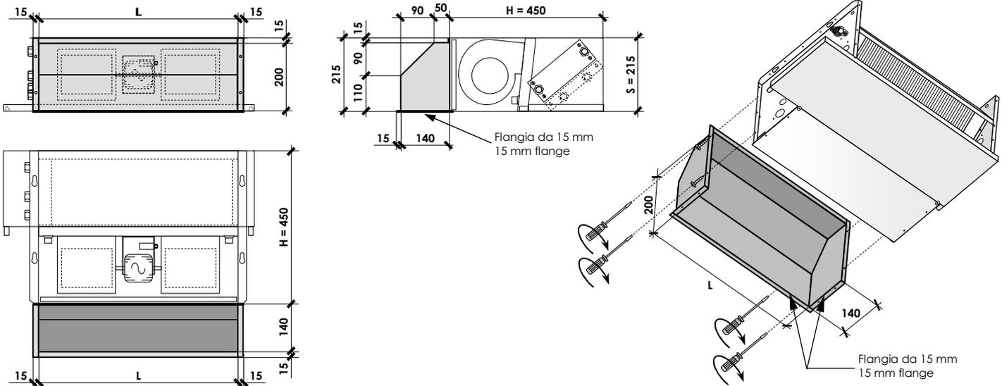
**Esempio 2 (Installazione su versione incasso verticale con mandata aria superiore e ripresa inferiore)**
