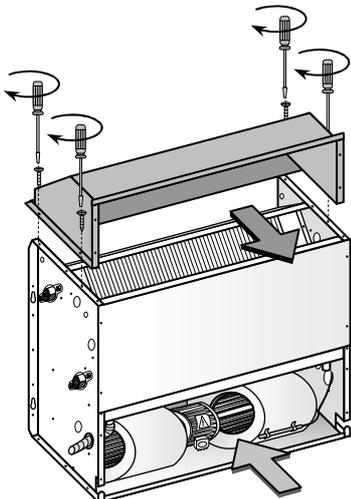
Esempio 3 (Installazione su versione incasso verticale con falso telaio e pannello di copertura)
