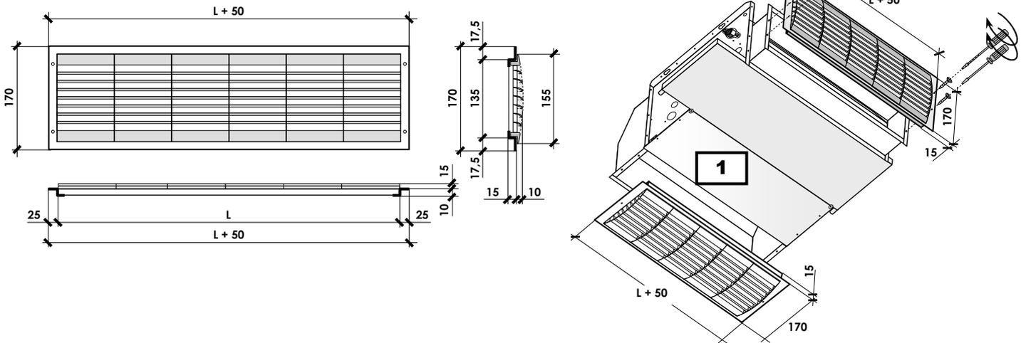
**Esempio 2 (Installazione su versione incasso verticale con mandata aria superiore e ripresa inferiore)**
